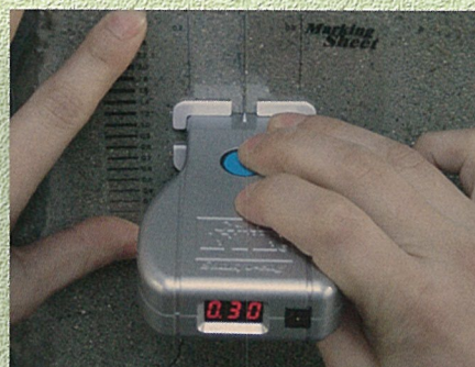
2.次にMarking Sheetの白い枠に合わせてCrack EYEをセットし、Crack EYEのボタンを押します。CrackEYEに測定結果が表示されます。
