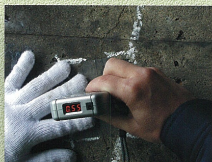
2.次にMarking Sheetの白い枠に合わせてCrack EYEをセットし、Crack EYEのボタンを押します。CrackEYEに測定結果が表示されます。
